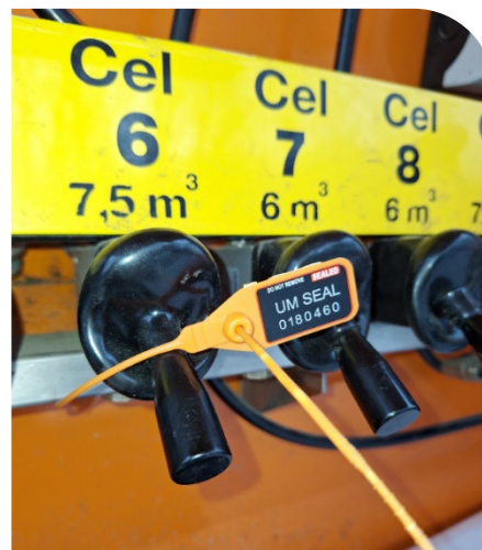
Fig. 3 - Scellement à l'arrière du camion au niveau des soupapes
